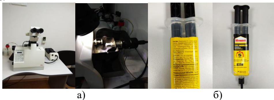
а) шлифовально-полировальная станции «LEICA EM TXP»; б) двухкомпонентный эпоксидный клей для склеивания медного кольца
