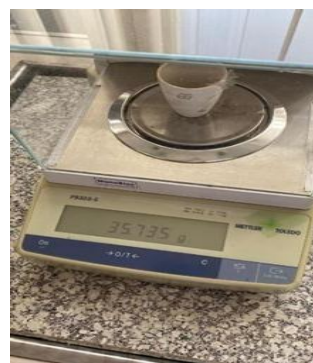
Сурет 5 – Өсімдік шикізатынан экстрактивті заттарды анықтау
