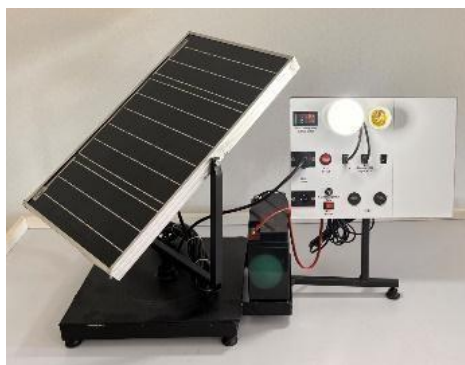
Сурет 4 – Фотоэлектрлік панельдің физикалық сипаттамаларын оқу-зерттеу стенді.
