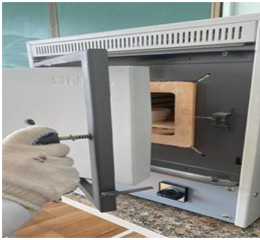
Сурет 2 – өсімдік шикізатының күлділігін анықтау
