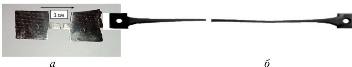
Рисунок 1. Образец сплава 47ХНМ толщиной 0,5 мм: а) после отжига и растяжения при комнатной температуре; б) после сверхпластической деформации при 950°C
