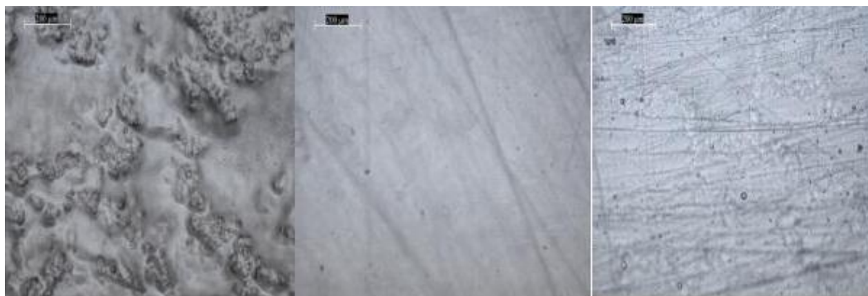
Рисунок 2. Оптические снимки пленок на основе ПВХ:КХ/пластификатор = 70:30 (а); 70:30/ \text{CaCO}_3 (1%) (б); 70:30/глицерин (1%) (в)
