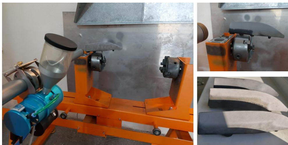
Рисунок 5.12 – Рабочие органы (долота сошника) после нанесения покрытия на основе Ti_3SiC_2
