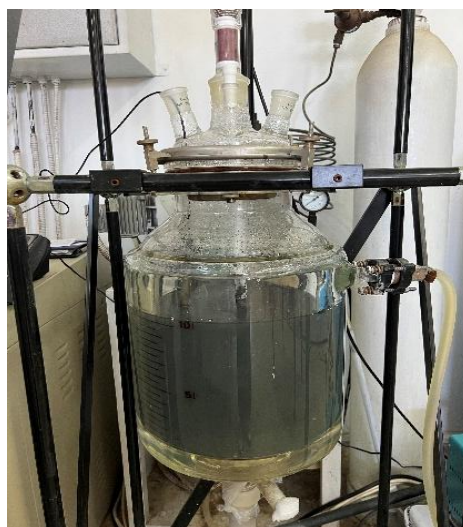
Рисунок 8 – Реактор марки S212-10L объемом 10 дм 3
