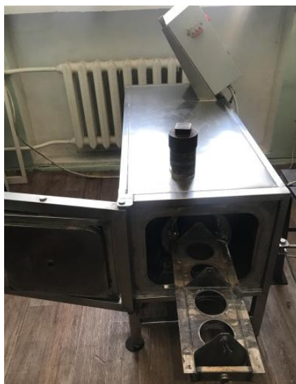
Рисунок 3 –Термостатированная установка с 6 автоклавами объемом 0,25 дм 3
