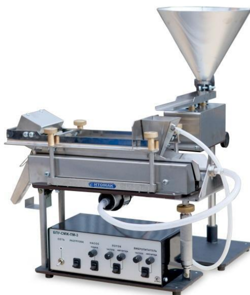
Рисунок 2 – Магнитный сепаратор БПУ-СМК-ПМ-3
