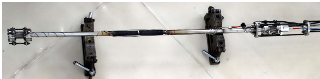
а) Внешний вид изготовленного ОУ с системой зеркал и поверхностным источником возбуждения газовых смесей для проведения экспериментов на реакторе ИГР
