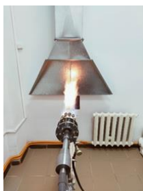
Спроектирована и изготовлена установка газотермического напыления с промышленным питателем на основе псевдосжигания жидкости.
