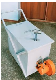
Спроектирована и изготовлена установка газотермического напыления с промышленным питателем на основе псевдосжигания жидкости.
