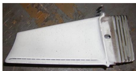
Теплозащитное покрытие ZrO_2
