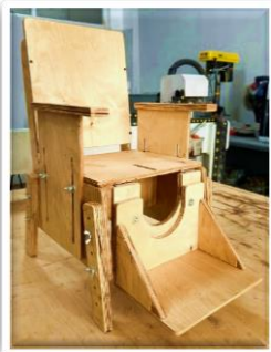
Модель рабочего стула со всеми регулируемыми частями для детей с ограниченными возможностями
