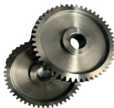
Электролитно-плазменная поверхностная закалка зубчатых колес
