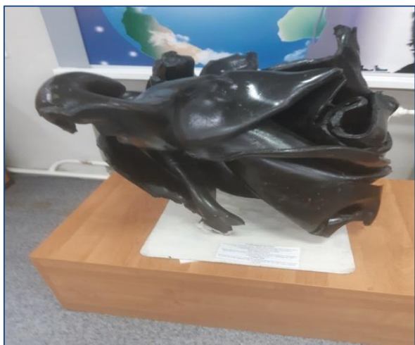
Сур.1. Ядролық жарылыстан кейін болат құбырды айналдыру нәтижесі (Курчатов қаласы мұражайының экспонаты).
