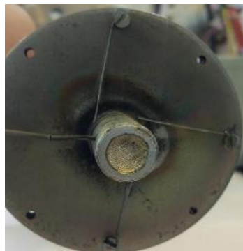
Рисунок 7 – Размещение литиевой КПС на мишенном узле ППУ
