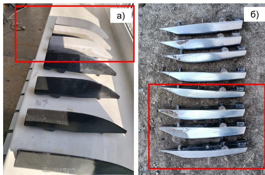
Рисунок 5.14 – Рабочие органы (долота сошника) с покрытием на основе Ti_3SiC_2 (а) до и (б) после испытания
