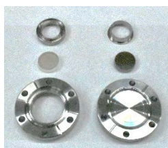
б) ответные фланцы на выравниватели ОУ с зеркалами
