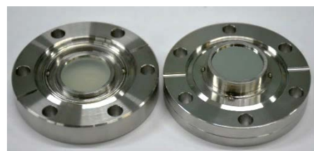
б) ответные фланцы на выравниватели ОУ с зеркалами
