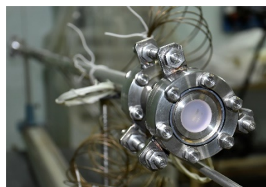
в) верхний выравнитель с вакуумным окном
