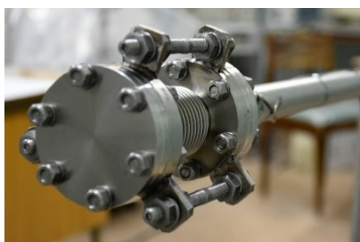
б) нижней выравнитель ОУ с фланцем-заглушка
