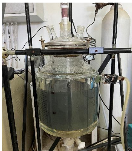
Рисунок 8 – Реактор марки S212-10L объемом 10 дм 3
