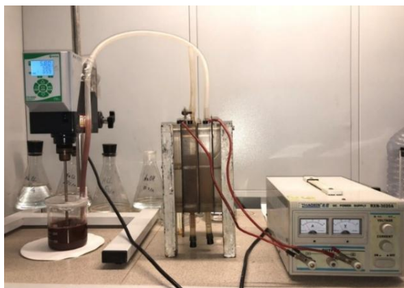
Рисунок 5 – Установка для выщелачивания золота гидрохлорированием
