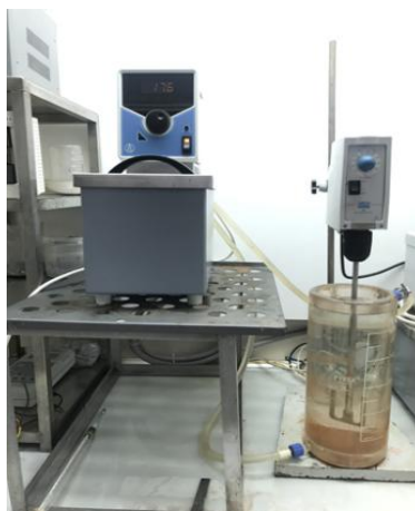
Рисунок 4 – Реактор с водяной рубашкой, объемом 2 дм 3
