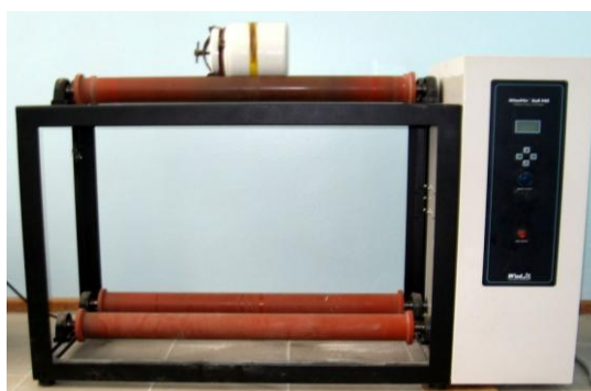
Рисунок 1 – Лабораторная мельница шаровая ВМЛ объемом 3 дм 3
