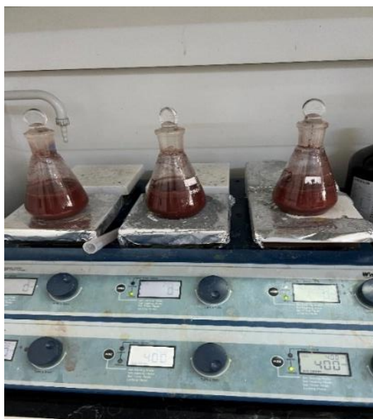
Рисунок 7 – Сернокисотно-тиомочевинное выщелачивание в магнитных мешалках в конических колбах емкостью 0,25 дм 3
