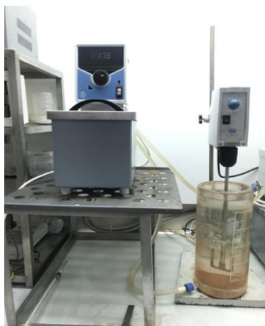
Рисунок 4 – Реактор с водяной рубашкой, объемом 2 дм 3
