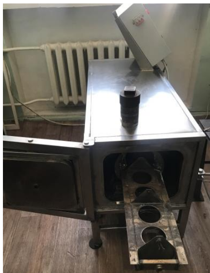
Рисунок 3 –Термостатированная установка с 6 автоклавами объемом 0,25 дм 3
