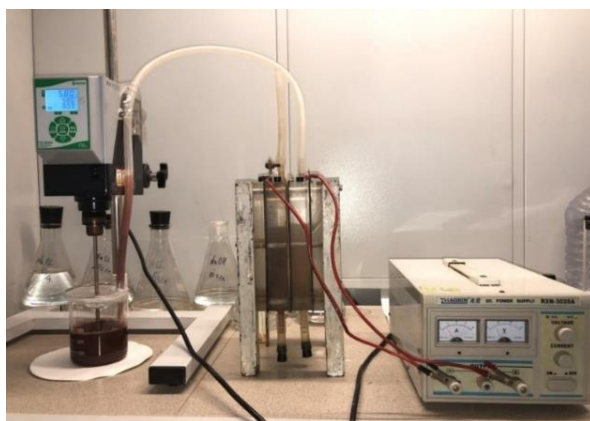
Рисунок 5 – Установка для выщелачивания золота гидрохлорированием
