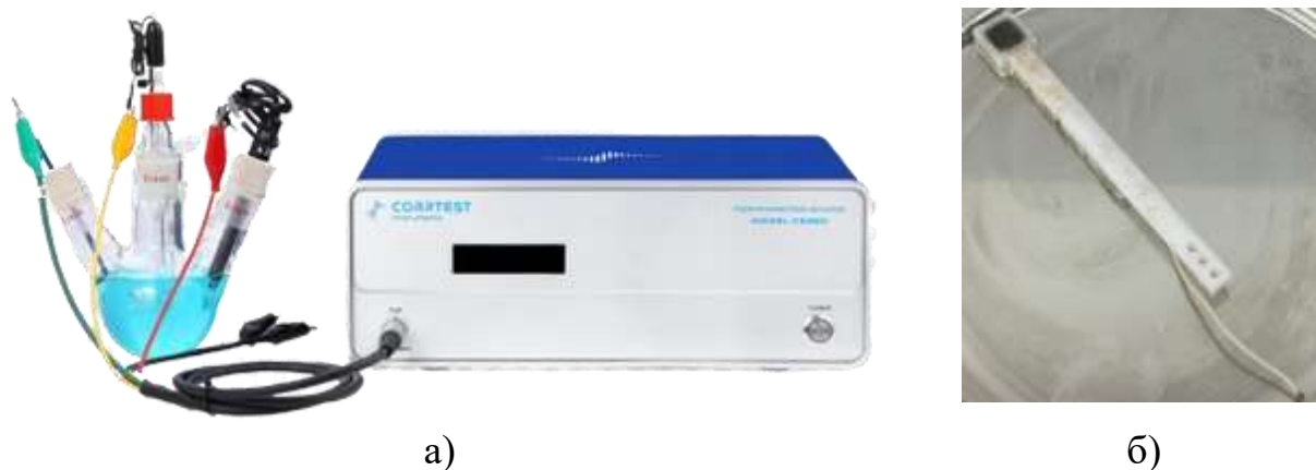
Сурет 2.9 – а) CS300M потенциостат-гальваностат, б) жұмыс электроды
