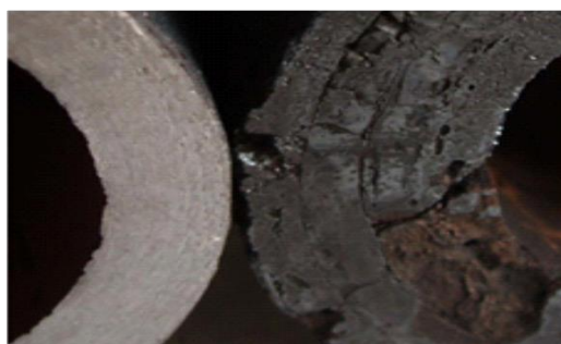
Сталь 12X1МФ до и после окисления
