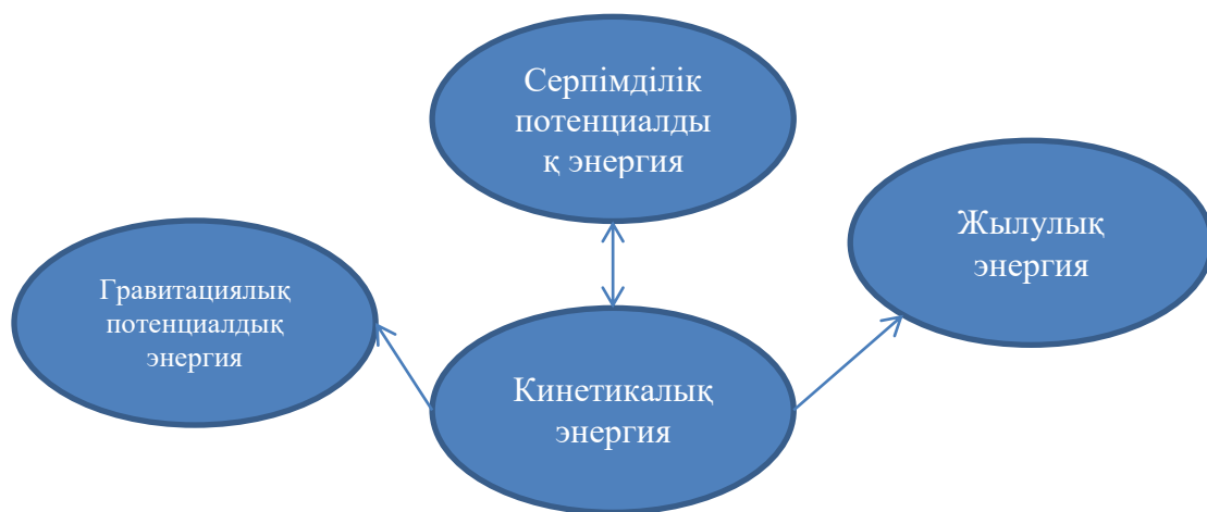
Сурет 25 - Серіппелі маятниктің энергия алмасу схемасы
