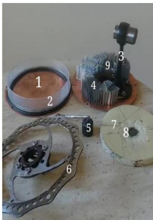
Сурет 34 – Стирлинг қозғалтқышының бөлшектері
