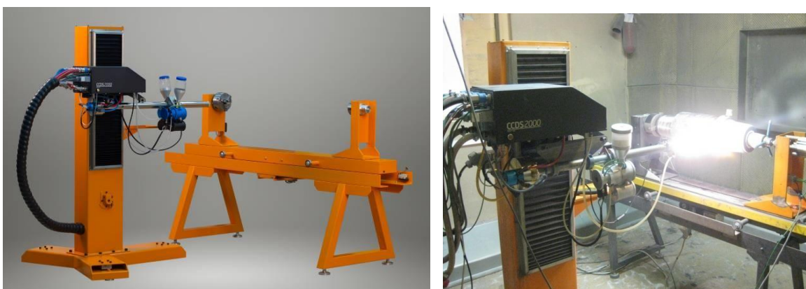
Сурет 3 – CCDS2000 детонациялық кешені
